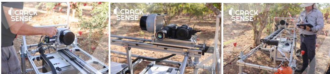
Slika 2. 3. i 4. TOMMY, robotski sistem opremljen termalnim i optičkim kamerama
